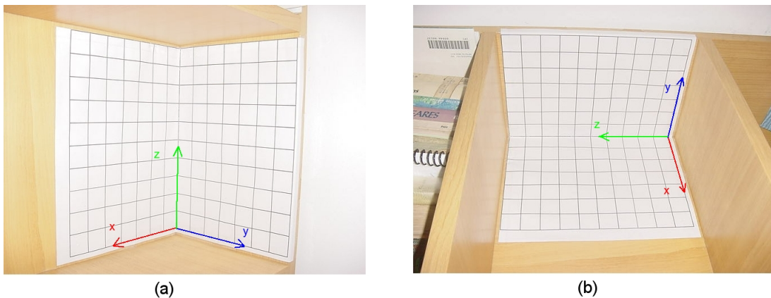
Figura 7.2: Imagens do objeto calibrador obtidas por uma mesma câmera posicionada de formas diferentes.
