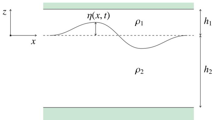
Figura 1: Configuração de um sistema com dois fluidos.
